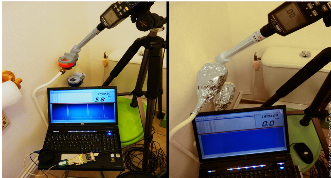
Stralingsmeting voor en na afscherming van de straling van de "slimme" watermeter 3 .
